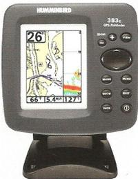
**383 cx - Έγχρωμο Βυθόμετρο GPS PLOTTER με ενσωματωμένη κεραία 16 δορυφόρων & χάρτη**
